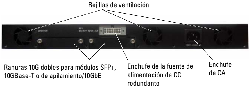
Ilustración 1-9. Panel posterior de PC7024P y PC7048P
