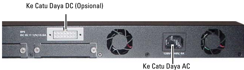
Gambar 1-15. Hubungan Daya AC dan DC ke Switch
